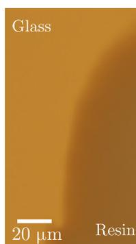
Fig.18：水中不可視傾斜樹脂の明視野観察像
